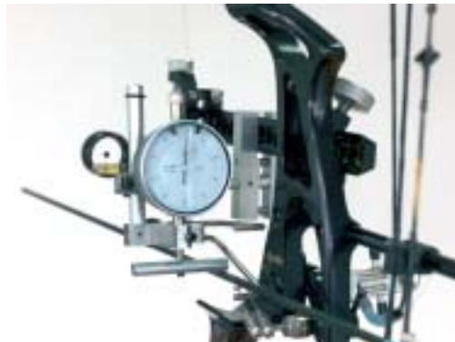
Placement de l'appareil pour le contrôle latéral de la sortie de flèche
