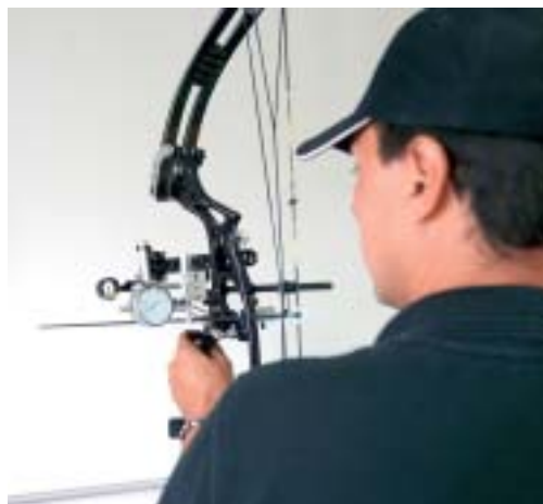
Réglage latéral de sortie de flèche. Mesure avec l'arc au repos
