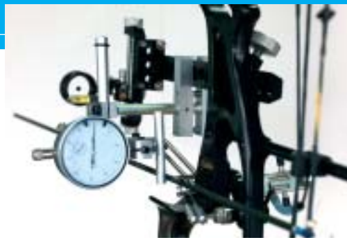
Placement de l'appareil pour le contrôle vertical de la sortie de flèche
